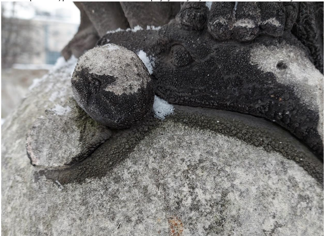
Fot.6. Figura Matki Boskiej Niepokalanej, Pl. Kossaka 4, Kraków . Widoczne charakterystyczne kalafiorowate nawarstwienia na powierzchni rzeźby. Na formach wypukłych powierzchniowe ubytki spowodowane odpadaniem patyny. Fot. D. Narowska Avonza, luty 2021.
